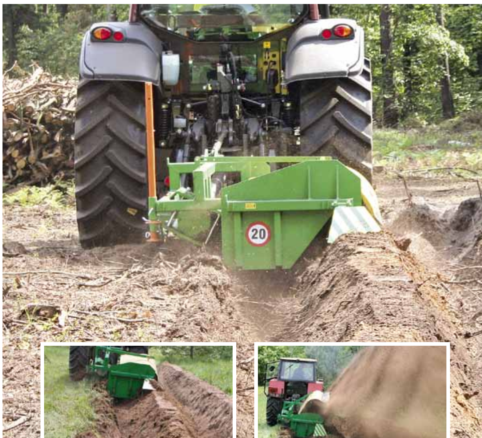
Z opuszczoną osłoną boczną Pługofrezarką wyrzucamy na bok ziemię z wyoranego rowka i jednocześnie formujemy obok wałek z rozdrobnionego materiału
