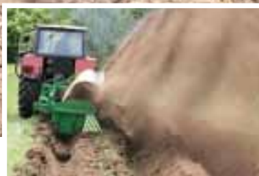
W wersji z podniesioną osłoną boczną Pługofrezarka może być wykorzystywana do tworzenia pasów p.poż lub zasypywania pożarzysk
