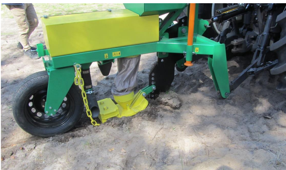
Rys. 4. Siewnik SZU zawieszony bezpośrednio na TUZ ciągnika..
