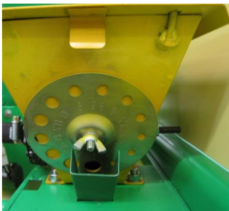
Rys. 15. Zbiornik siewnika małego z aparatem siewnym..
