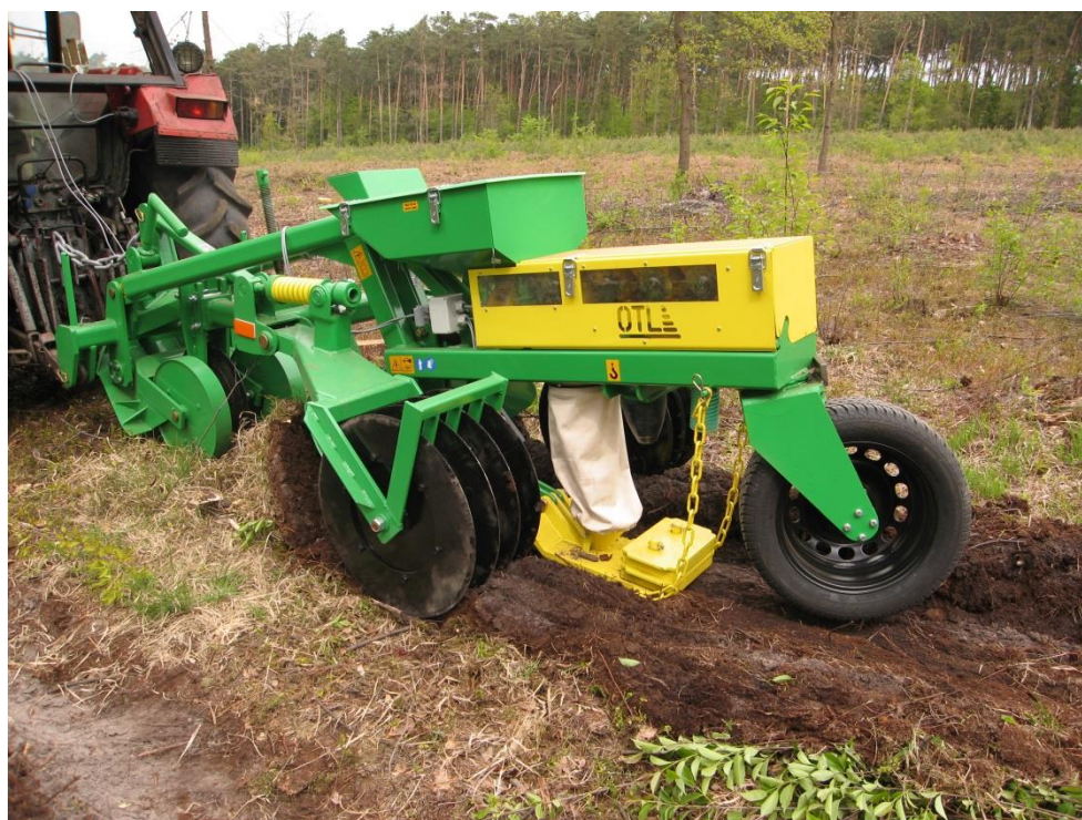
Rys. 2. Widok ogólny siewnika SZU. w wersji z pługiem LPz-OTL.
