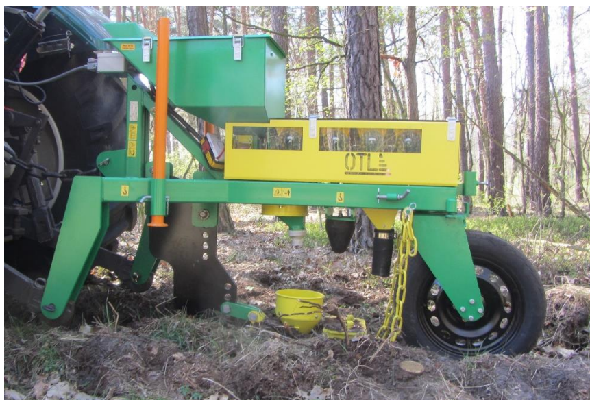
Rys. 26. Wysiew centralny ze wszystkich siewniczków (zdemontowany również rękaw osłaniający lecz pozostawiony kołnierz podwyższający lejek w płozie)
