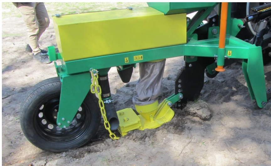
Rys. 28. Wysiew na boki z siewników tylnych..
