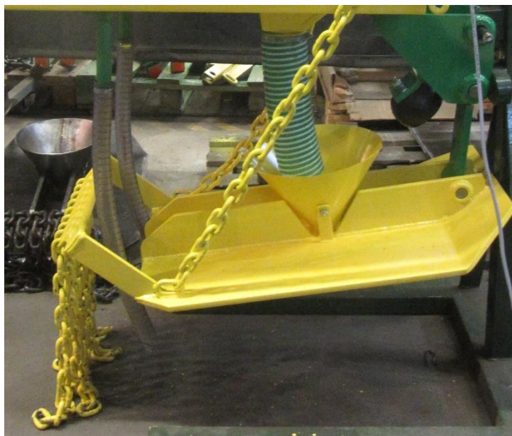
Rys. 13. Ploza siewna siewnika SAU – widok ogólny.
