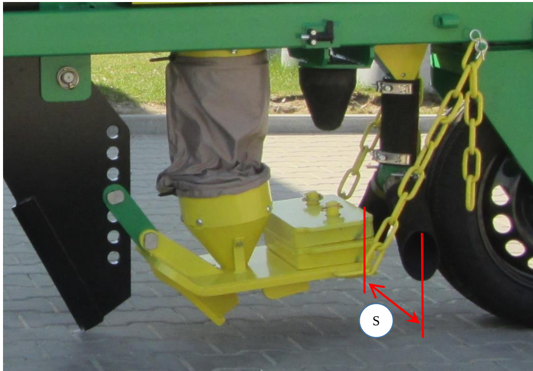
Rys. 27. Siewnik SZU do pługa LPz (do wysiewu na boki nasion z tylnych siewniczków). S – teoretyczna szerokość wysiewu domieszek
