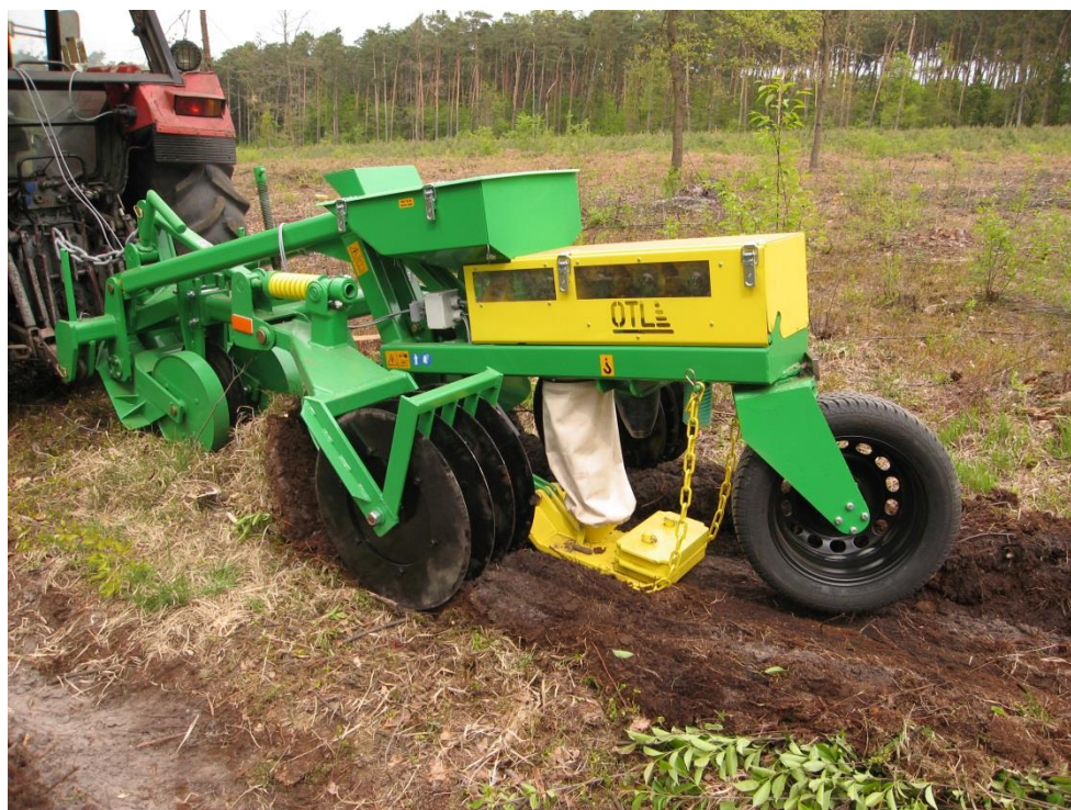
Rys. 20. Widok ogólny siewnika SZU. Widoczna zamontowana osłona płócienna.
