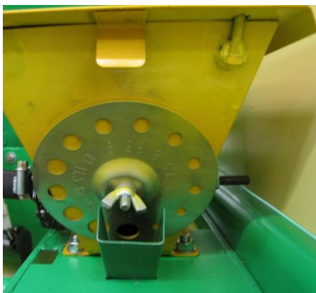
Rys. 16. Regulacja ilości wysiewanych nasion przez obrót tarczki..
