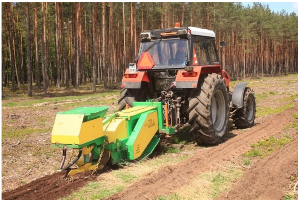
Rys. 3. Widok ogólny siewnika SAU. w wersji z frezem FL-OTL.
